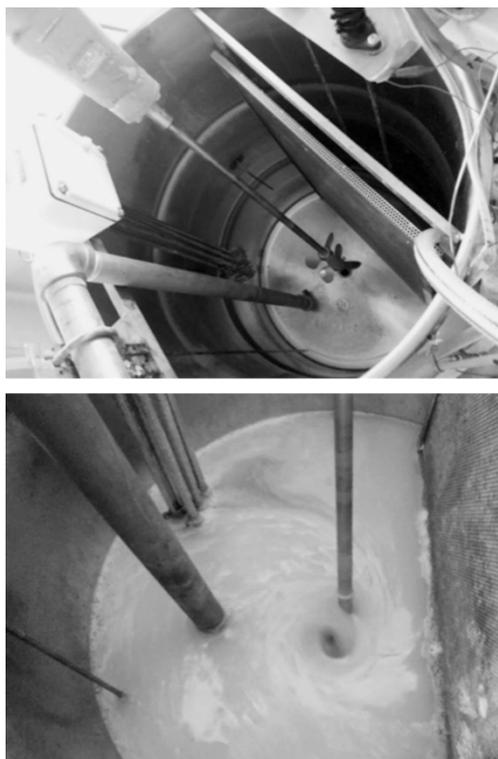
図4 攪拌機とヒータを備えた200 L容量のスラリー調製タンク
